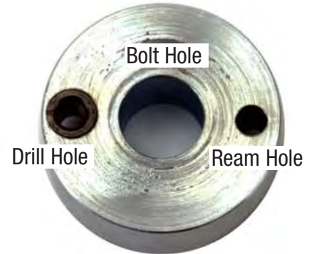
(1x) - Crank Pinning Drill Guide
